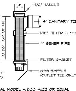
OUTLET EFFLUENT FILTER
