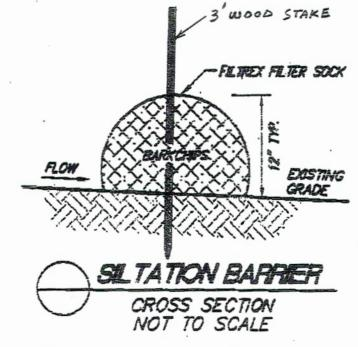
\* SECURE SILTATION BARRIER WITH WOOD STAKE EVERY 10 FEET ALONG BARRIER REVISION [] 7/7/21 MODIFIED EROSION CONTROL AND ADDED LIMIT OF WORK FOR SAS PER CON. COM. DE)
